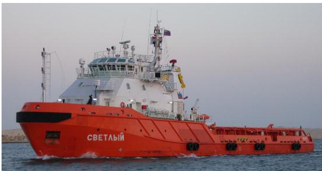
The Russian 60 ton BP AHTS SVETLYY – Photo : Jan de Bokx ©
