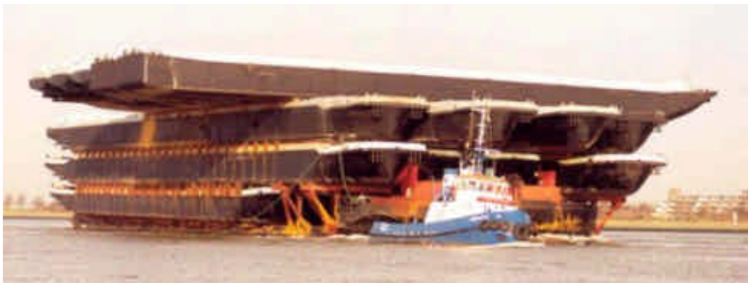
Deze plaat laat een deel van een wel heel bijzonder transport zien. Het betreft hier een ponton, geladen met een veelvoud aan in China gebouwde binnenschepen, die in Nederland nog moeten worden afgebouwd. De sleepboot welke aan de stuurboordzijde voor op het ponton vast staat om bij te kunnen sturen, lijkt van geringe afmetingen.
