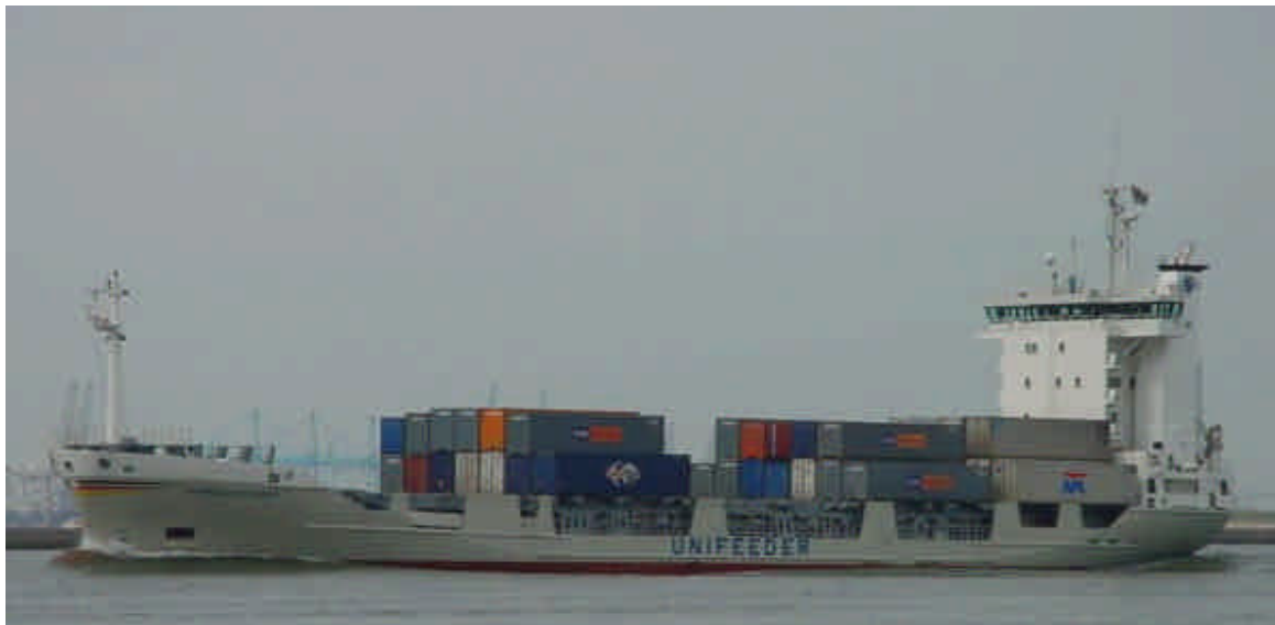
P & O NEDLLOYD RUSSIA (9113745) W. Rambow Drochtersen 1995 Sietas Hamburg GT 39999 dwt 5210 TEU 508 Loa 100.6m Bm 18.5m ex Gerda-02. – Foto/text : Jan van der Klooster
