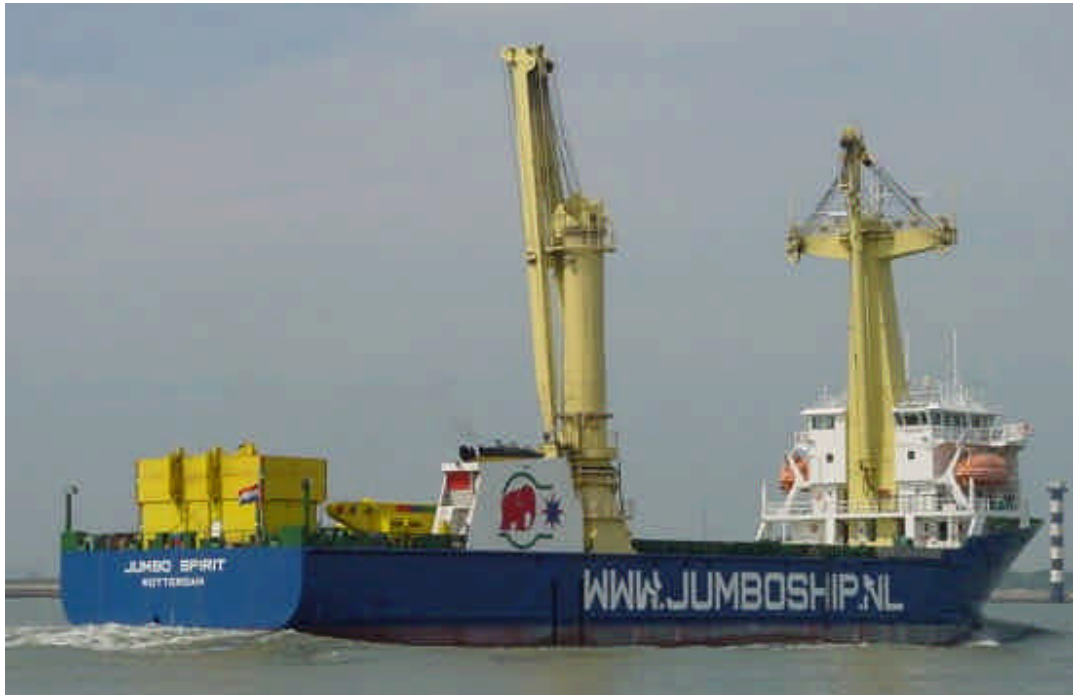
JUMBO SPIRIT (9083122) Kahn Scheepvaart Rotterdam 1995 IJsselwerf Capelle a/d IJssel GT 4962 dwt 5200 TEU 300 Loa 95.6m Bm 18.4m Waalhaven naar Jacksonville foto/text: Jan van der Klooster
